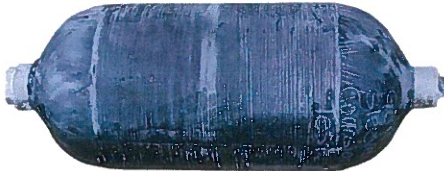
Figure 16: Attaque chimique (degré 3)
