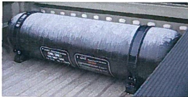
Figure 15: Dommages dus aux intempéries (degré 1)
