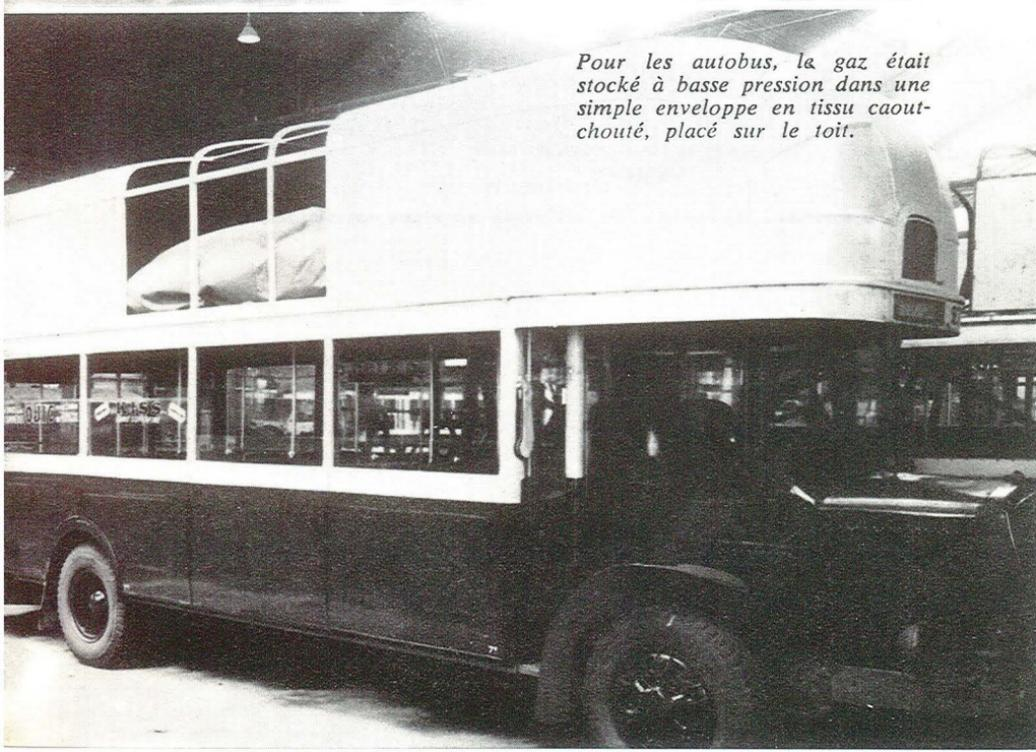
*Pour les autobus, le gaz était stocké à basse pression dans une simple enveloppe en tissu caoutchouté, placé sur le toit.*
